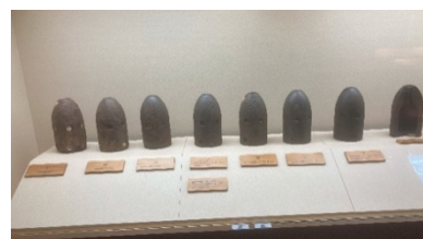
砲弾を使って脱塩や保存処理の効果の程度を示す。左側の未処理から右側の完全な保存処理をした砲弾まで段階的に展示
