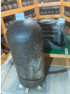
汽笛用タンク(手前)と海水を真水にする換水装置
